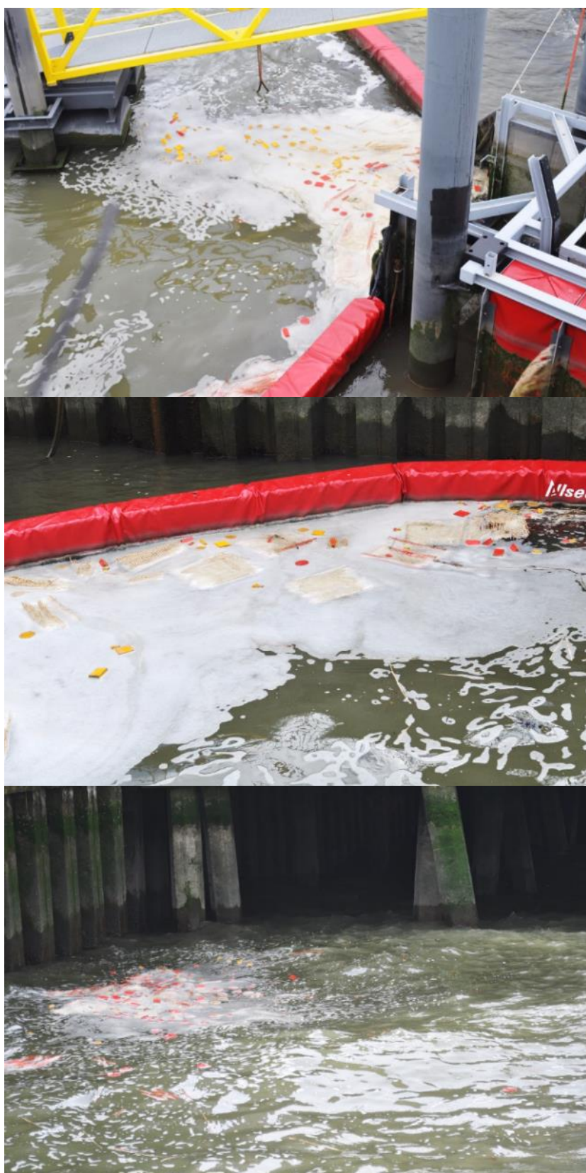
Figuur 5-7: Een deel van de tracers hoopt zich voor de plasticvanger op. Een deel van de tracers drijft een stukje weg langs de kade van Mammoet.
