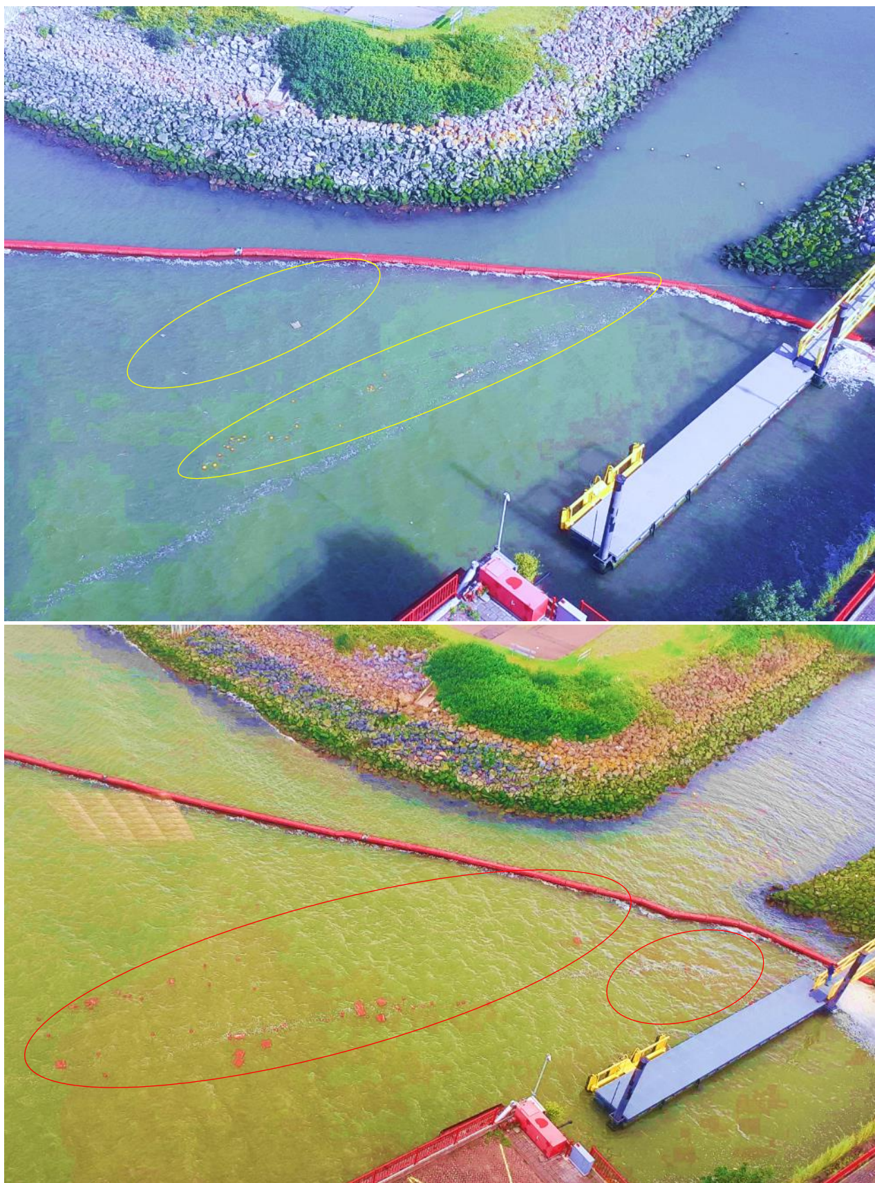
Figuur 5-5: De tracers vloeien langzaam richting plasticvanger. Het traject van de rode en gele tracers is gelijkaardig. Alleen de gele stukken bamboegordijn namen een bredere bocht omheen de kade van Mammoet en arriveren iets verder bij de afleider.
