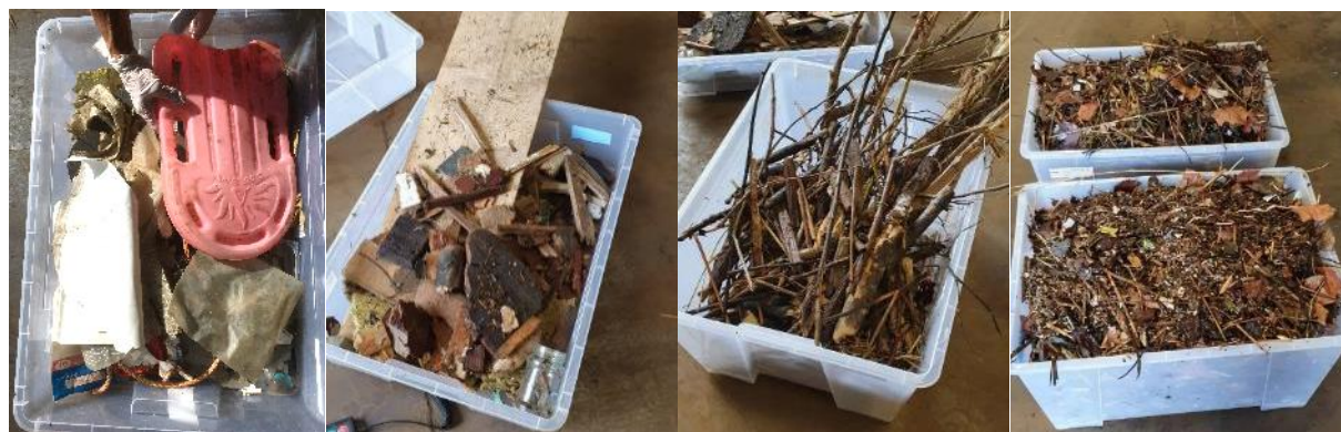
Figuur 6-2: Stap 2 van het behandeling proces – Het afval wordt gesorteerd in verschillende types materiaal. Van links naar rechts: plastics, overig, biomassa, mix.
