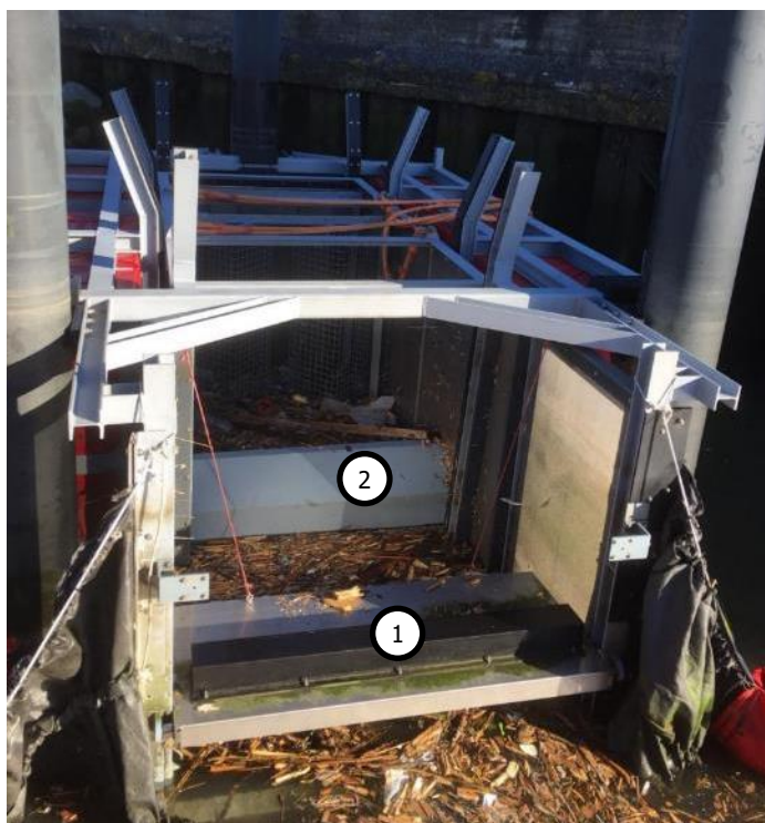
Figuur 3-12: In combinatie met de terugslagklep (1) aan het drijvende frame, zorgt de drempel (2) ervoor dat het vuil niet uit het systeem ontsnapt.
