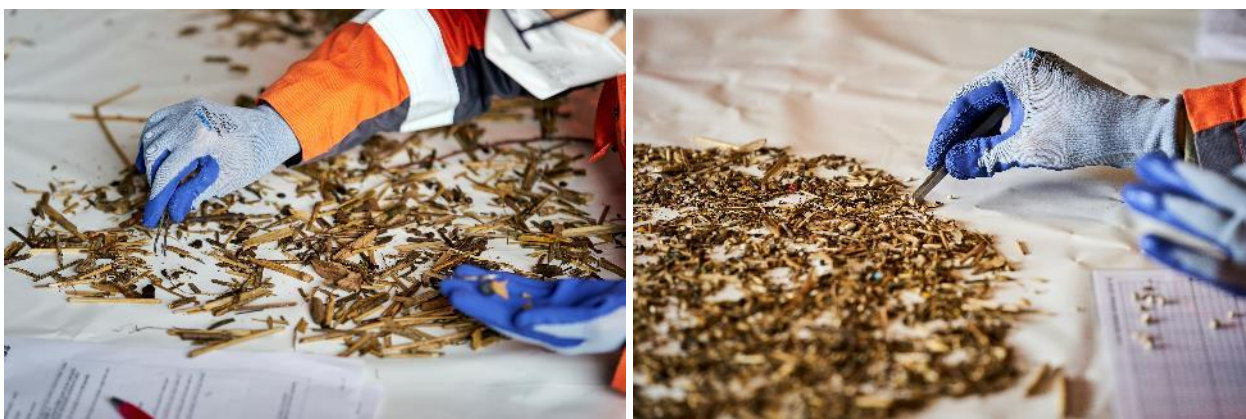
Figuur 6-6: Stap 3 van het behandeling proces – De < 5 mm en 5-25 mm mix afval worden gesorteerd per type materiaal.
