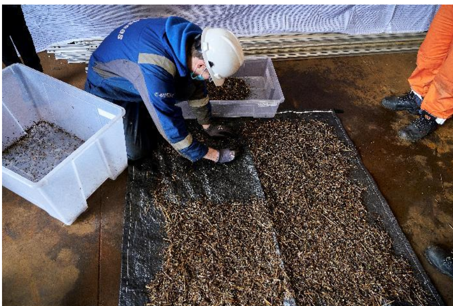
Figuur 6-5: Stap 2 van het behandeling proces – Monsterneming van de < 5 mm mix afval.
