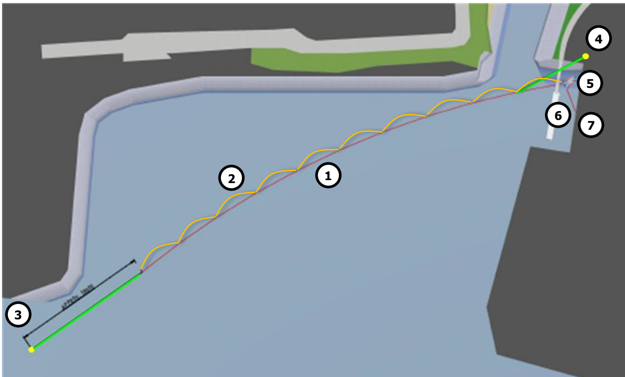
Figuur 3-2: De 200 m afleider (1) bestaat uit 10 secties van 20 m die aan elkaar en aan een Dyneema lijn verbonden zijn (2). Hij is afgemeerd aan een paal van DFDS Seaways (3), aan een bolder van RWS bij de kade van Mammoet (4) en aan één van de spudpalen waar het vangstelsel is afgemeerd (5). De 12 m afleider (6) is gemaakt uit een unieke sectie. Hij is afgemeerd aan de vangst (4) en aan de kademuur van Mammoet (7).
