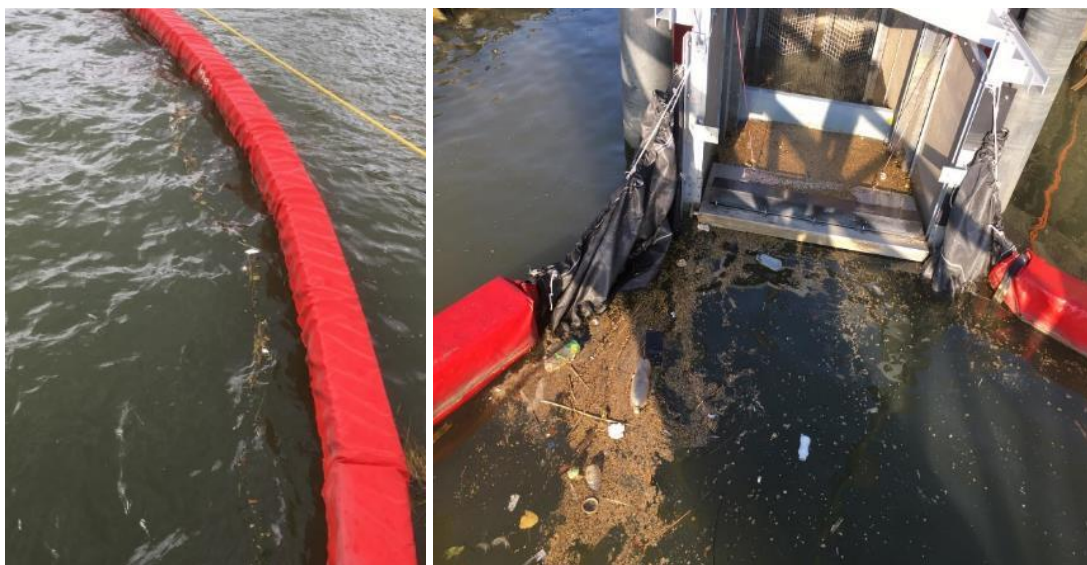
Figuur 4-1: Het vuil wordt geleidt door de vangarmen naar het opvangstelsysteem, met behulp van wind en stroming.
