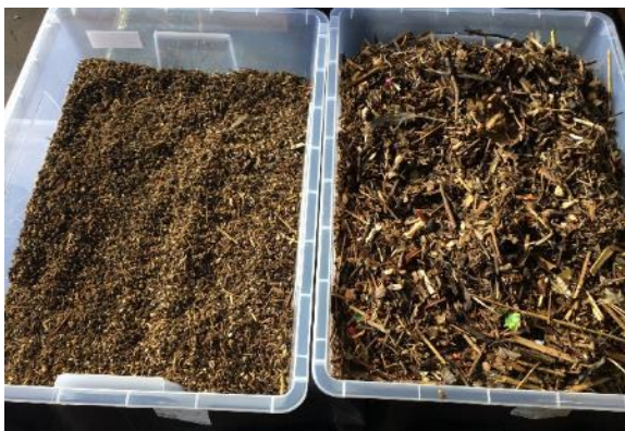
Figuur 6-4: Stap 2 van het behandeling proces – Mix afval na zeven – Links < 5 mm, rechts 5-25 mm
